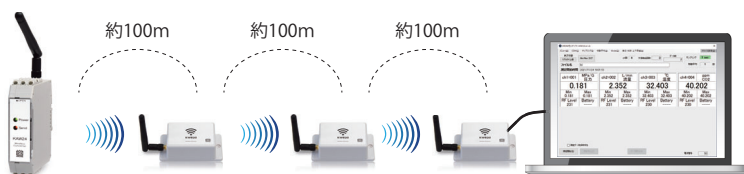
(例)中継器3台の増設(周波数帯 920MHz の場合)
