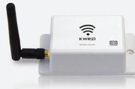
専用受信器 (親機) をパソコンに USB 接続をし、KS3200 本体 (子機) から送信されたデータを受信します。
