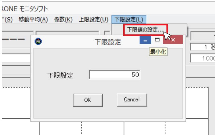
下限設定 50 にした場合、測定データが下値（下記の例では 50kPa）を下回ると測定データ部が青く点滅します。
