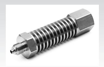
高温媒体から圧力計を保護するための冷却用放熱器です。 ヒートシンクを使用すると、例えば測定媒体の温度が 120℃ で周囲温度が 30℃の場合、圧力計へ伝わる温度を 60℃近辺 まで下げる事ができます。
