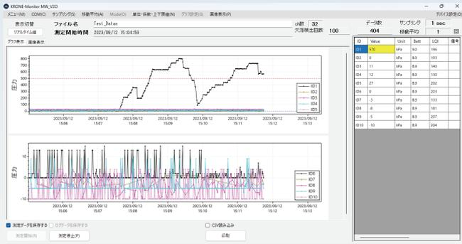
グラフ表示の他、各チャンネルには圧力値、最大・最小圧力値の他、電池電圧や通信レベル等が表示されます。
