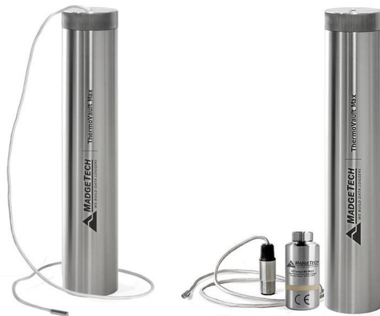
DHS システムは温度ロガー HiTemp140-M12 と SUS 製の高温耐熱ケースを使用した、超高温温度モニタリングシステムです。HiTemp140-M12 の温度センサーには白金抵抗体 Pt-100 を使用しており測定精度は-200 ~ +400°C の間で ±1.2°C と高精度です。
