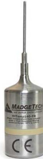
温度ロガーHiTemp140-FR は、65,536 メモリーを有する温度データロガーです。温度センサーには温度応答が素早い白金抵抗体 Pt-100 を使用しており測定精度は  $\pm 0.1$  と高精度です。
