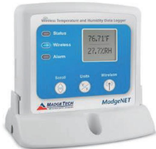
ワイヤレス温湿度ロガーRFRHTemp2000A は、16,128 メモリーを有する温湿度データロガーです。RFRHTemp2000A は 1 秒~24 時間の間で指定した測定間隔で測定中の温度と湿度データをパソコンにリアルタイムで転送し、同時に本体内部メモリーに温湿度データを測定日時とともに保存します。
