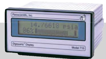
モデル 715 は、デュアル RS-232、RS-485 インターフェースを備え全 Paroscientific インテリジェントトランスミッターからの圧力および温度データを表示します。2 行 16 文字英数字表記、バックライト付きの液晶ディスプレイは、付属のソフトウェアを使用しユーザ自身で構成することが可能です。また、RS-232 ポート又は RS-485 ポートを使用し、トランスミッター、コンピュータ、その他のシリアルホストからのディスプレイコマンドに応答します。スタンドオン操作の場合、トランスミッターに電力が供給されている限りディスプレイにデータが表示されます。
