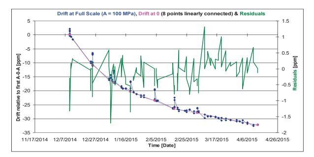
その後2年間ほど、Paroscientific 本社でも80台ほどの圧力計(フルスケール水位3000m)を用いて A-0-A テストが行われた。例えば2015年11月3日から2015年12月29日まで20台のセンサーが フルスケール圧力下で保持され、定期的なA-0-A 手法によってフルスケールA値と0値のドリフトを 計測した。その内の19台のセンサーはその後数ヶ月ほど大気圧に開放されたが、また2016年4月 19日から2016年8月19日までフルスケール圧力下でA-0-A測定が行われた。この2つの試験の結 果、全センサーの平均的スパンドリフト(A値のドリフトから0値のドリフトを差し引いた物)はバ ラつきが水位+/-1.4cmで平らなグラフになった(この値は標準として使われたDWTの水位3000m という圧力値における、+/-5ppmの不確定さでもある)。下の図では、青のグラフがゼロ点での平均 ドリフト、ピンクのグラフがフルスケール値での平均ドリフト、そして緑のグラフがその2つの差で ある。赤のグラフは試験中の20台のセンサーの温度である。
