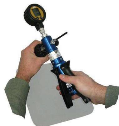
5 ... 5.5 MPaは上の写真のように圧力を発生させます。このプロセスでは、下側のハンドグリップを滑り止めの土台に置くことが重要です。
