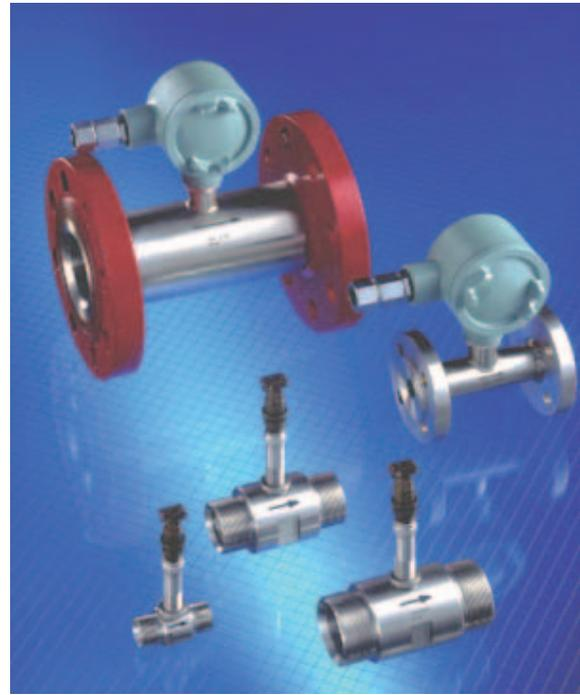
VTRシリーズは、頑強なボディで厳しい条件下においても精密な測定を行います。SUS304または316で製作、ローター部はタングステンカーバイトで耐圧もMAX250barです。更に、広いレンジ(max45090l/min)と高精度(±0.5%リーディング)を実現し、あらゆる分野で採用いただいております。ネジタイプ(DN50まで)とフランジタイプが選定できます。各種アプリケーションに対応します。
