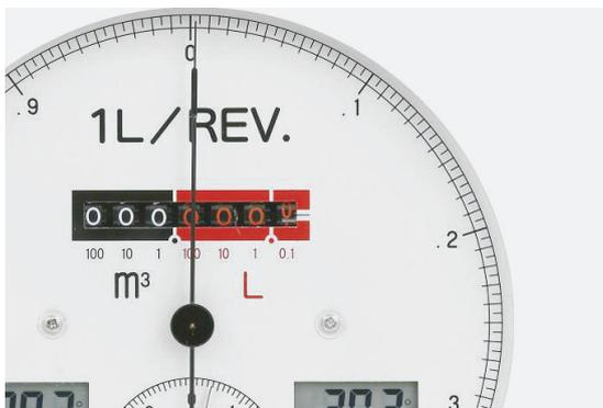
水またはオイル等の液体でシールされたドラムを計量エレメントとする実量式積算流量計のため、比重・粘度に影響されず殆どガス体を計量することができます。また、リークする事のない構造になっているため、微小流量でも必ず計量し、再現性が高い等の優れた特長があります。
