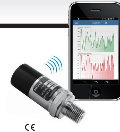
通信機能を備えた M5600 シリーズはステンレスボディにポリカーボネードのカバーで構成され、24bit デジタル出力を Bluetooth® で通信します。あらゆる気体、液体に使用が可能で特に汚水、スチーム、弱腐食性の媒体にも対応します。(316L を腐食させない媒体)
